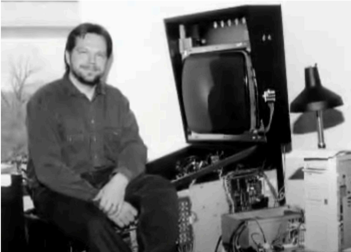
Ein erster Prototyp mit senkrecht stehendem Röhrenmonitor.
